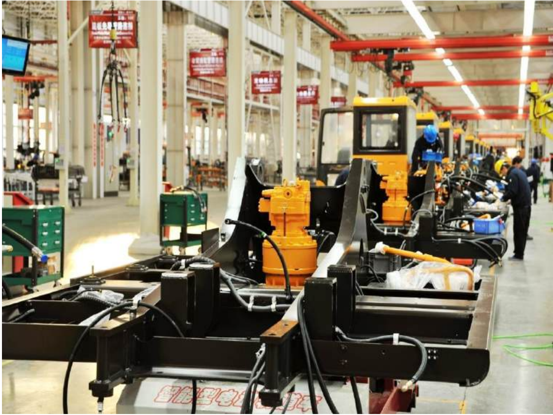
Dây chuyền lắp ráp máy xúc
