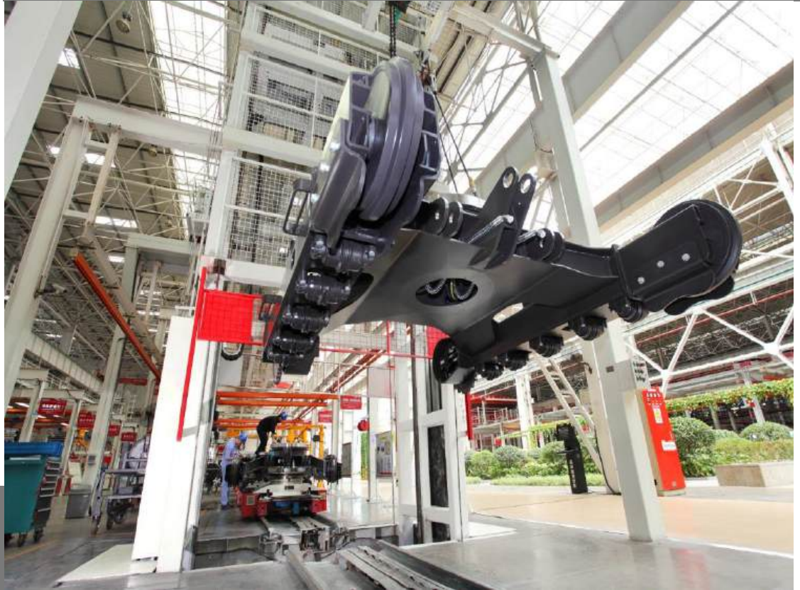
Dây chuyền lắp ráp máy xúc
